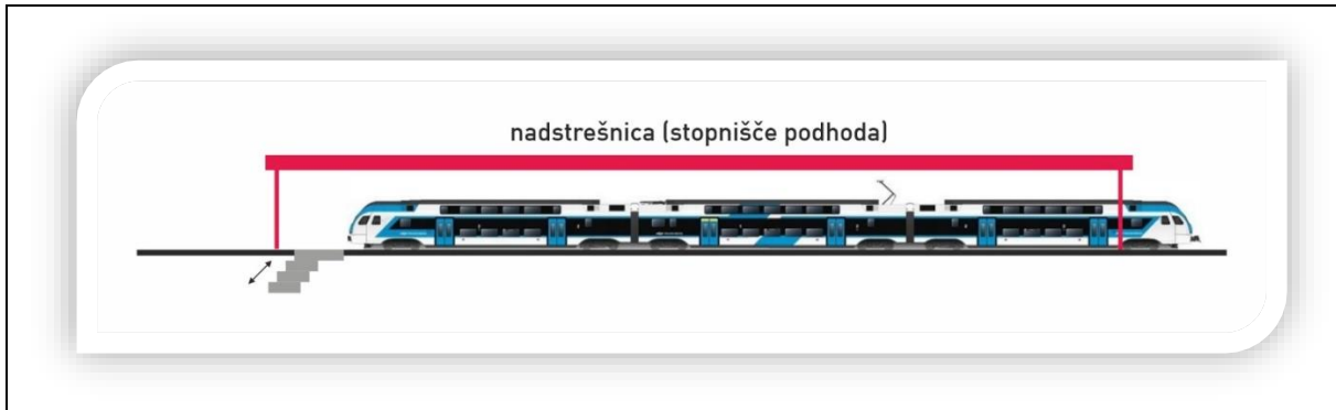
Slika 4.4.2: Prikaz dolžine nadstrešnice na peronu, ki omogoča, da bodo potniki zaščiteni pred vremenskimi vplivi, zlasti dežjem in snegom, pri čemer so upoštevani mesto ustavitve vlakov, mesto, s katerega potniki dostopajo na peron in vlak, in lega stopnišča podhoda; vir: DRI 2021.
