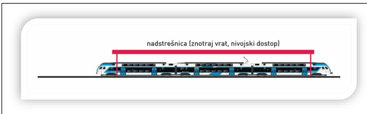
Slika 4.4.3: Prikaz dolžine nadstrešnice na peronu, ki omogoča, da bodo potniki zaščiteni pred vremenskimi vplivi, zlasti dežjem in snegom, pri čemer so upoštevani mesto ustavitve vlakov in mesto, s katerega potniki dostopajo na peron in vlak; gre za nivojski dostop – stranski peron ob postajnem posloplju; vir: DRI 2021.
